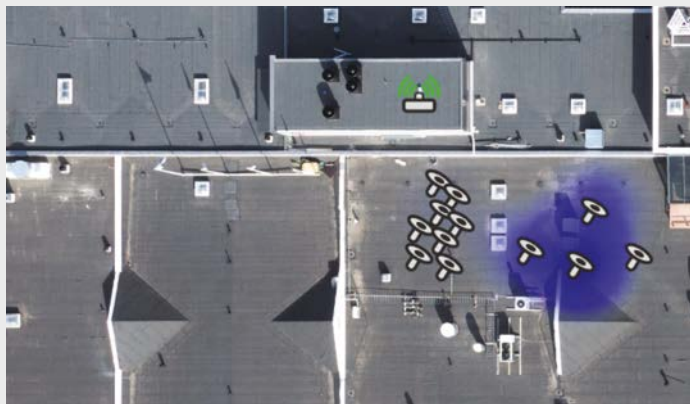
Każde zdjęcie dachu o odpowiednich wymiarach nadaje się do stworzenia mapy wilgotności.
