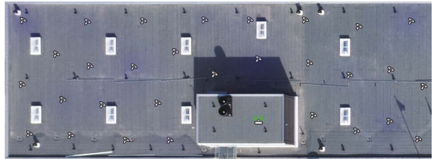
W tym przykładzie powierzchnia dachu wynosi około 600 m² i jest monitorowana przez 30 czujników.
